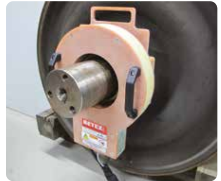
Erwärmung eines Labyrinthrings zur Demontage
